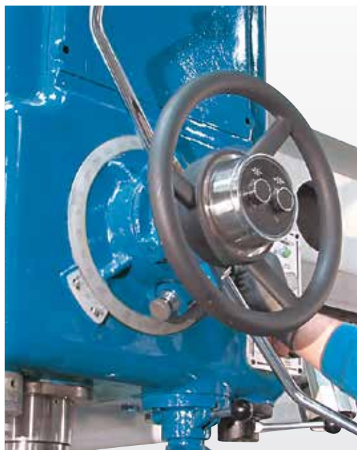
Упор ограничения глубины с нониусом
