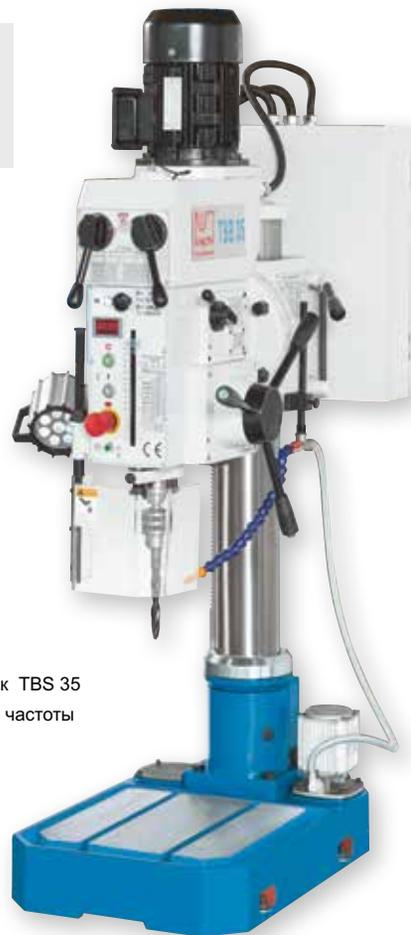
На фото изображён станок TBS 35 с цифровым индикатором частоты вращения шпинделя
