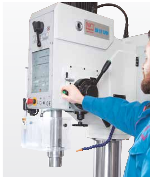
Автоматическую подачу можно включать и выключать непосредственно на поворотной крестовине
