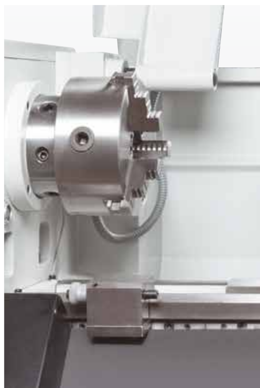
Микрометрический упор станины гарантирует высокую точность повтора
