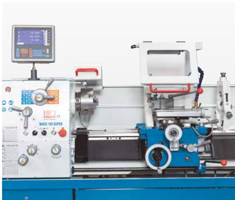
Выбор подходящей частоты вращения шпинделя токарного станка Basic 180 Super с помощью 16-ступенчатого редуктора
