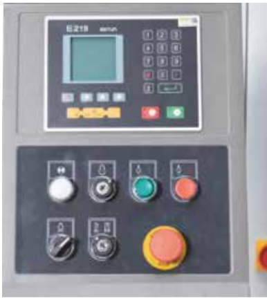
NC-Steuerung für schnelles Positionieren des Hinteranschlags
